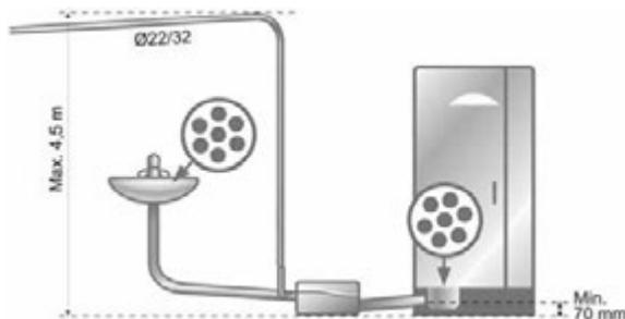
**Рис. 51.** Для раковины и душевой кабины (SOLOLIFT2 D-2)
