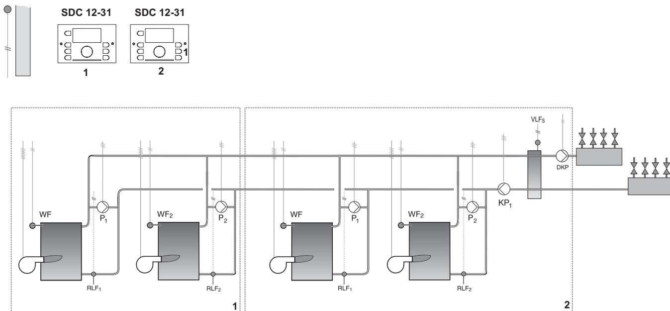
Данная схема применяется при совместной работе четырех одноступенчатых газовых котлов в каскаде. Также осуществляется управление байпасными насосами для каждого котла отдельно
