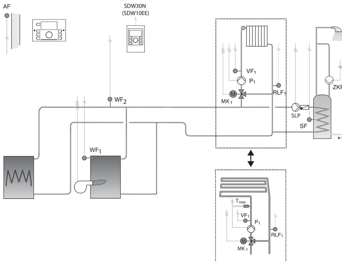
Данная схема применяется при совместной работе электрического и газового котлов. При этом электрический котел может работать по многотарифному счетчику в ночное время, а газовый котел — в дневное.
