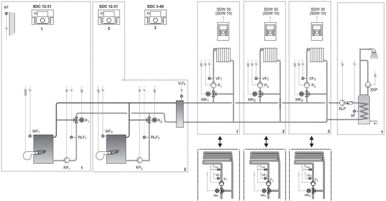
Данная схема применяется при совместной работе двух двухступенчатых газовых котлов в каскаде. Также осуществляется контроль над температурой воды на входе в каждый котел
