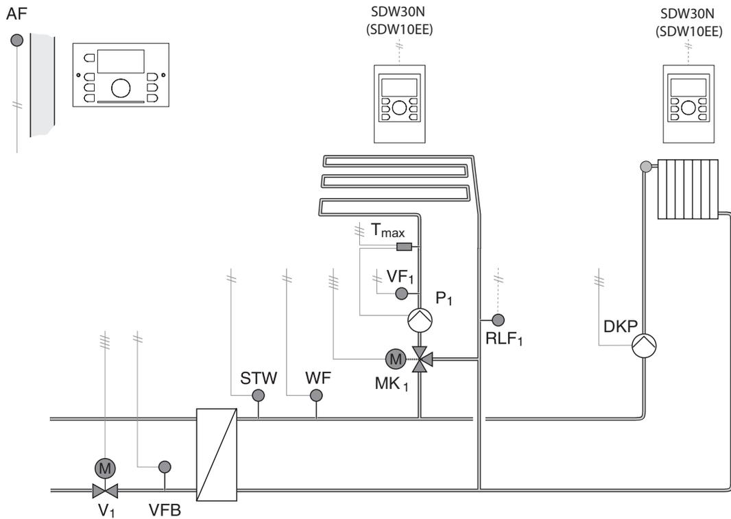
Стандартная гидравлическая схема 0507. Контроллер SDC7-21N. DHC режим
