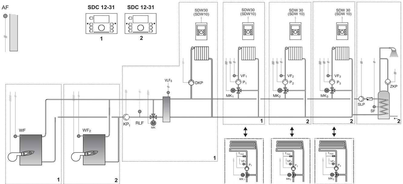
Данная схема применяется при совместной работе двух двухступенчатых газовых котлов в каскаде. Также осуществляется контроль над температурой воды на входе в котлы
