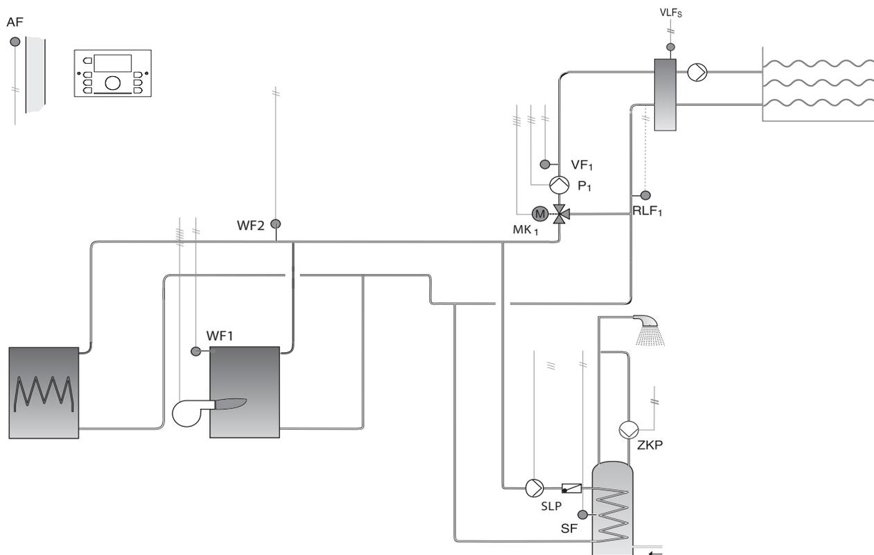
Данная схема применяется при совместной работе электрического и газового котлов. При этом электрический котел может работать по многотарифному счетчику в ночное время, а газовый котел - в дневное. Также по данной схеме может осуществляться поддержание необходимых параметров температуры воды в плавательном бассейне.
