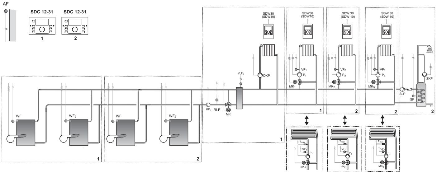
Данная схема применяется при совместной работе четырех одноступенчатых газовых котлов в каскаде. Также осуществляется контроль над температурой воды на входе в котлы
