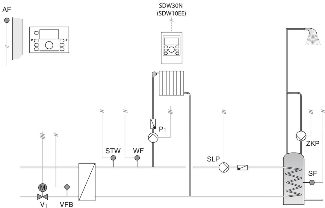
**Стандартная гидравлическая схема 0503. Контроллер SDC7-21N. DHC режим**
