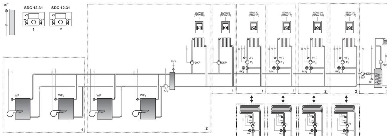
Данная схема применяется при совместной работе четырех одноступенчатых газовых котлов в каскаде.
