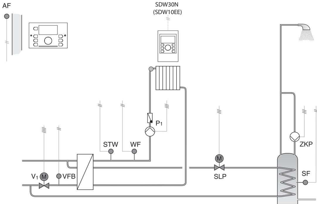
**Стандартная гидравлическая схема 0504. Контроллер SDC7-21N. DHC режим**
