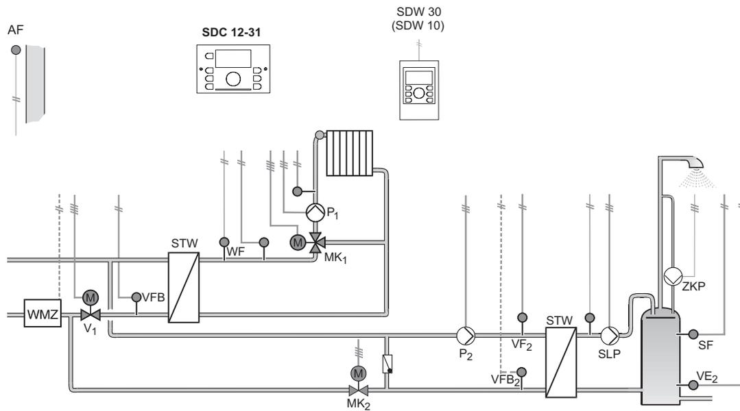
**Стандартная гидравлическая схема 0511. Контроллер SDC12-31N. DHC режим**
