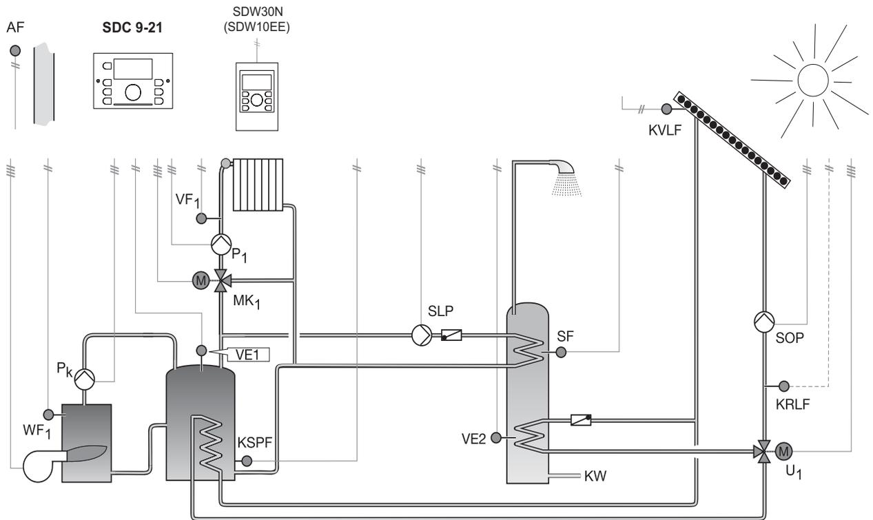
Данная схема применяется при совместной работе газового котла, солнечного коллектора и использовании буферной емкости
