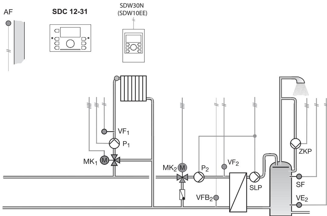
**Стандартная гидравлическая схема 0514. Контроллер SDC12-31N. DHC режим**
