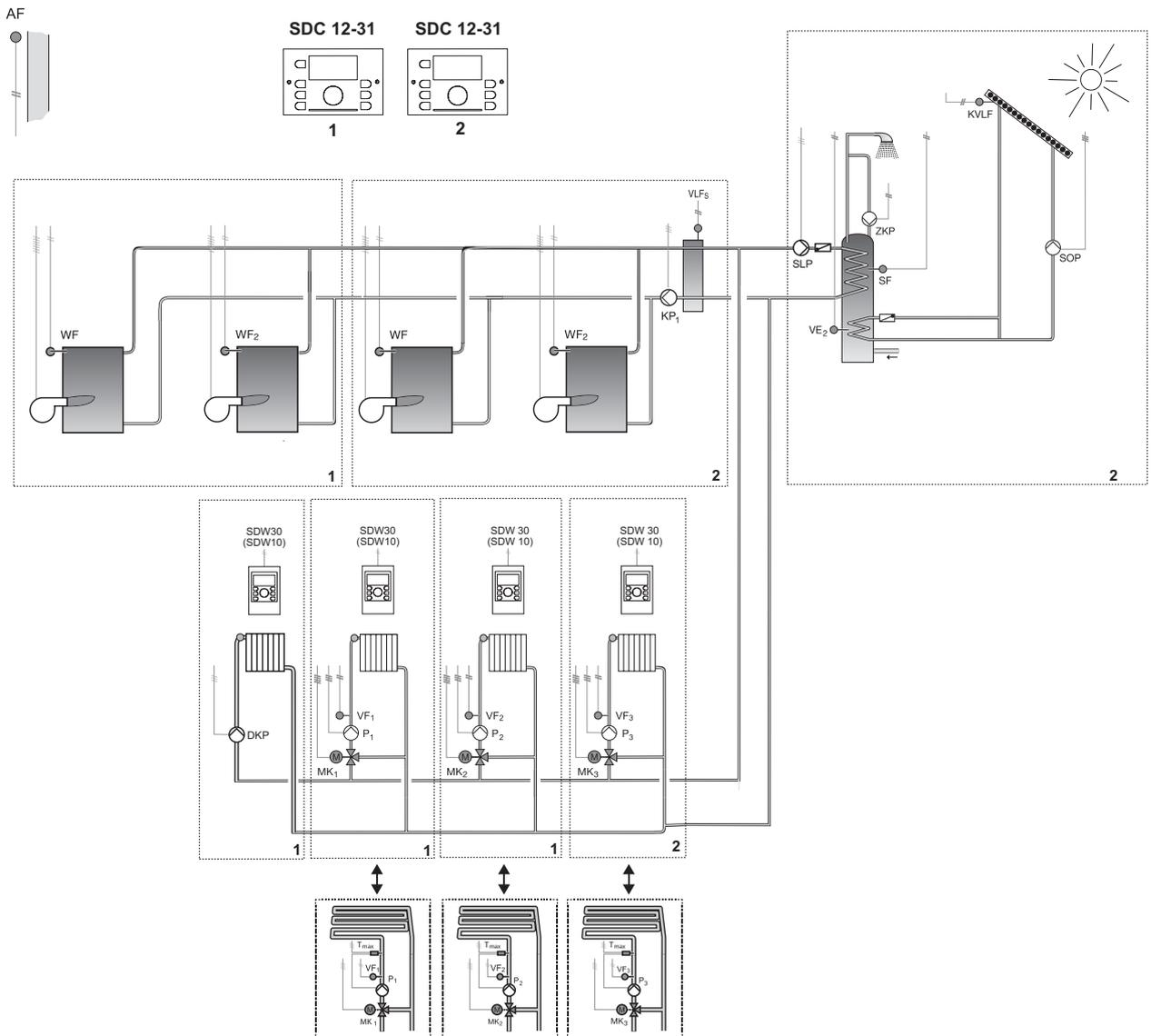
Данная схема применяется при совместной работе четырех одноступенчатых газовых котлов в каскаде и солнечного коллектора.
