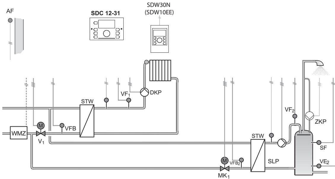
**Стандартная гидравлическая схема 0513. Контроллер SDC12-31N. DHC режим**
