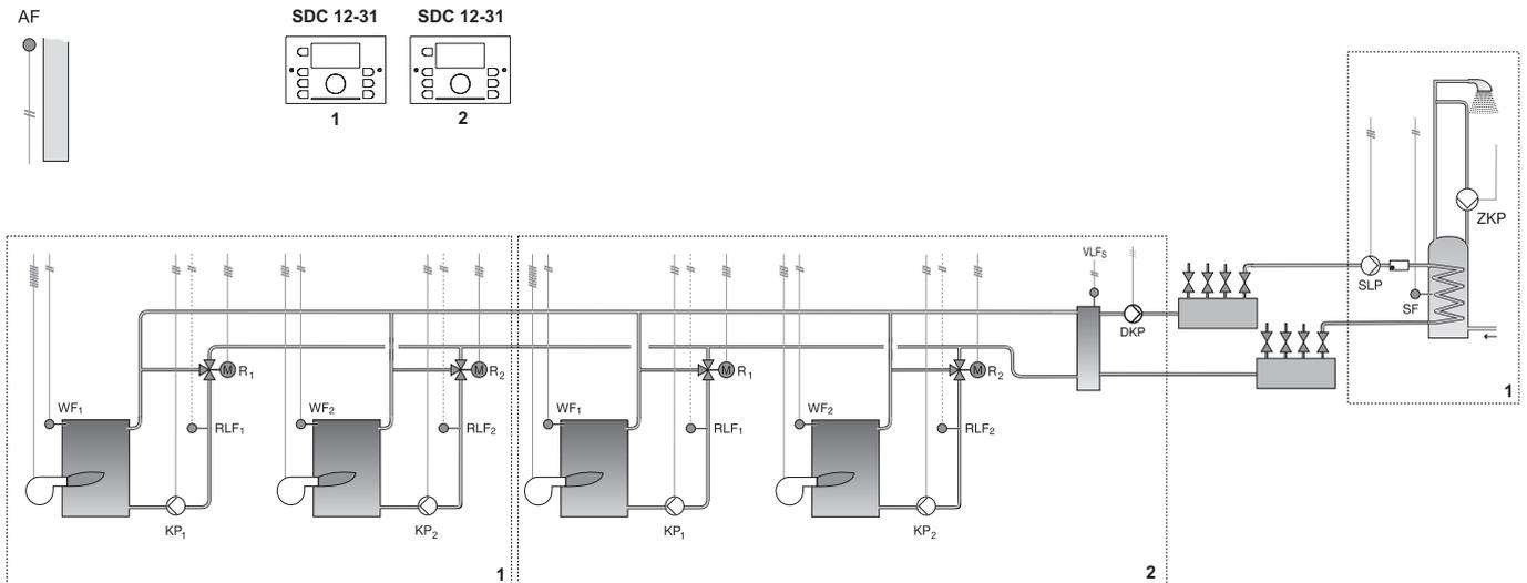
Данная схема применяется при совместной работе четырех одноступенчатых газовых котлов в каскаде. Также осуществляется контроль над температурой воды на входе в каждый котел отдельно
