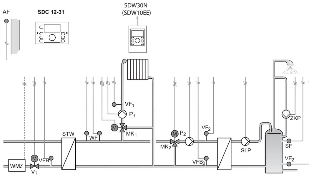
**Стандартная гидравлическая схема 0510. Контроллер SDC12-31N. DHC режим**
