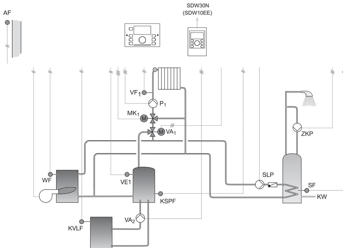
Данная схема применяется при совместной работе одноступенчатого газового котла, теплового насоса и использовании буферной емкости. В этом случае тепловой насос являются базовыми для нагрева воды в буферной емкости
