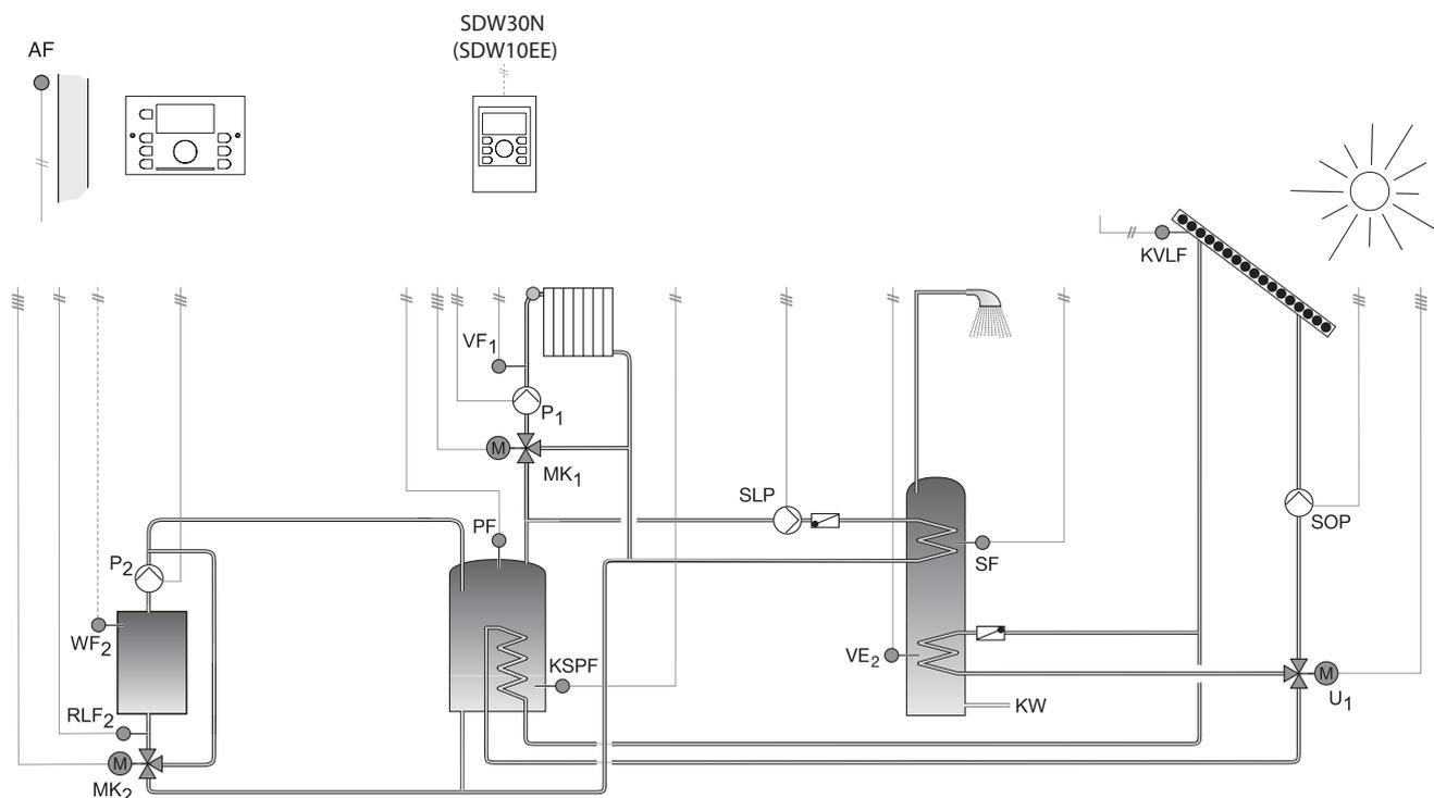
Данная схема применяется при совместной работе твердотопливного котла, солнечного коллектора и использовании буферной емкости
