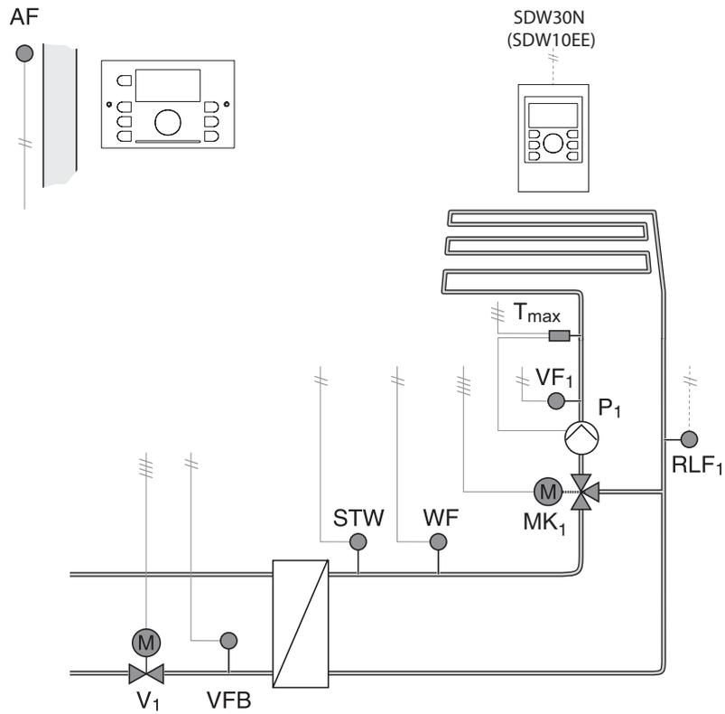
**Стандартная гидравлическая схема 0506. Контроллер SDC7-21N. DHC режим**
