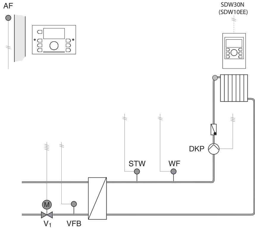
**Стандартная гидравлическая схема 0502. Контроллер SDC7-21N. DHC режим**
