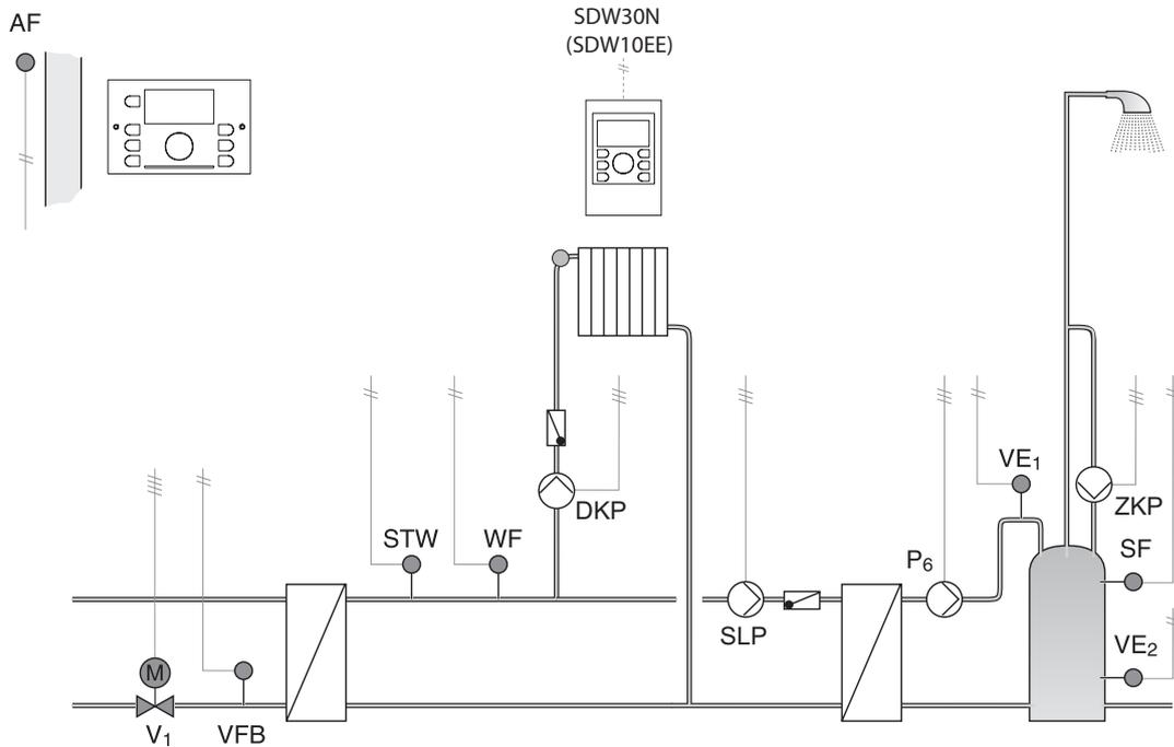
**Стандартная гидравлическая схема 0505. Контроллер SDC7-21N. DHC режим**
