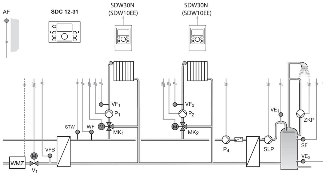
**Стандартная гидравлическая схема 0512. Контроллер SDC12-31N. DHC режим**
