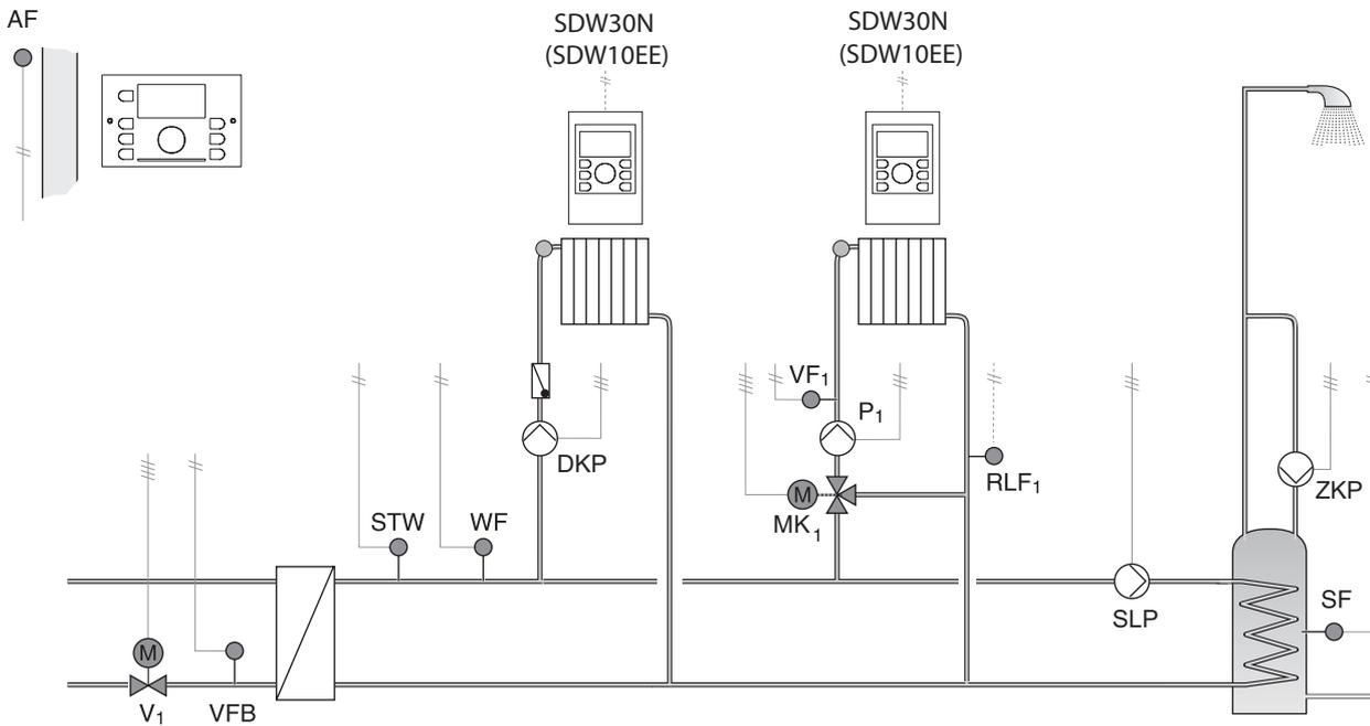
**Стандартная гидравлическая схема 0509. Контроллер SDC12-31N. DHC режим**
