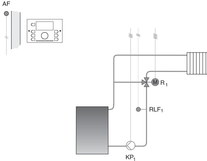
Данная схема применяется для контроля температуры воды на входе в котел
