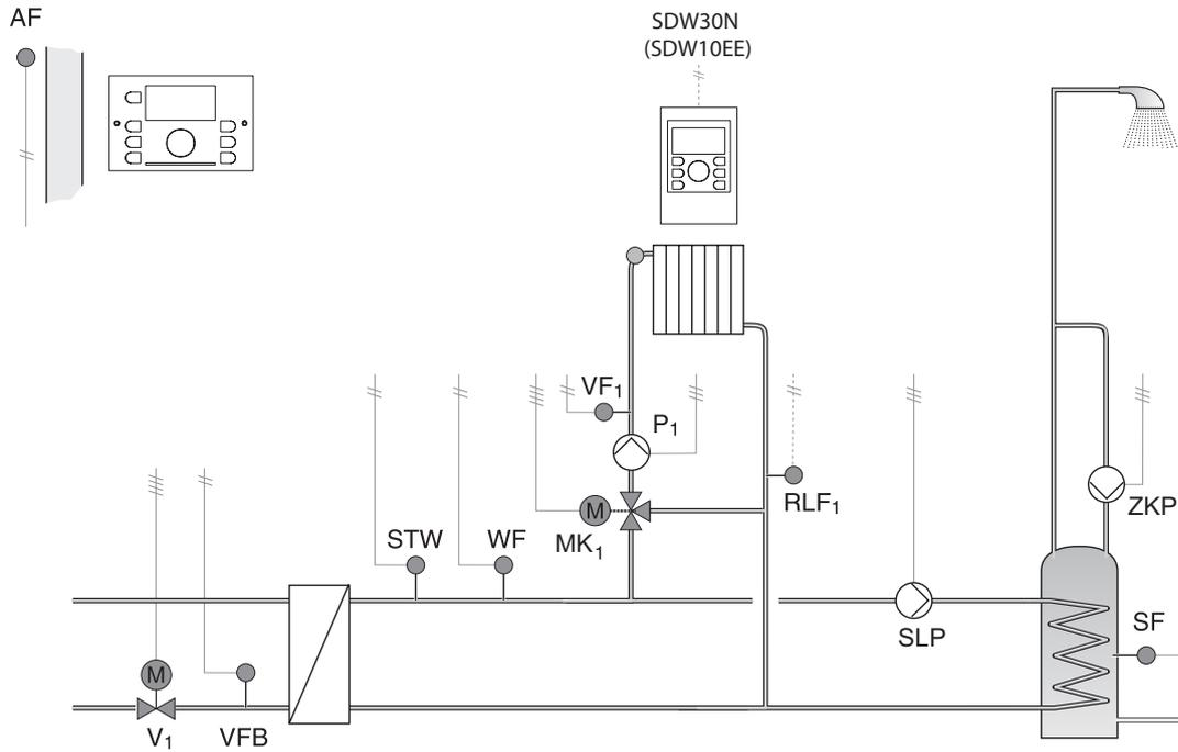
Стандартная гидравлическая схема 0508. Контроллер SDC9-21N. DHC режим
