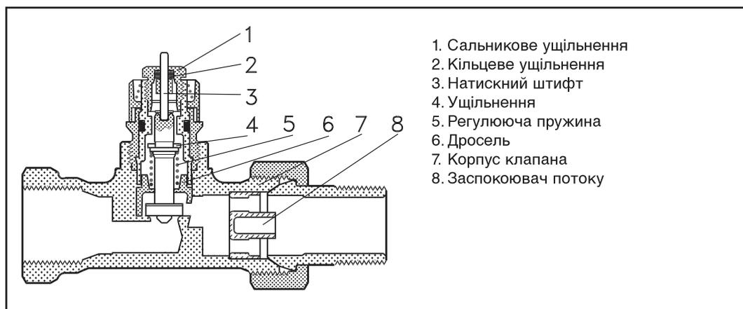
До складу радіаторного терморегулятора входять регулюючий клапан RA-N і термостатичний елемент серії RA, котрі замовляють окремо.
