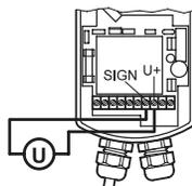
Для дистанционного мониторинга положения шарового клапана нужно использовать потенциальны вход системы управления 0...10В. Максимальный ток 10 мА. При напряжении до 0.5 В шаровый клапан открыт, а при напряжении 5...6 В шаровый клапан закрыт.
